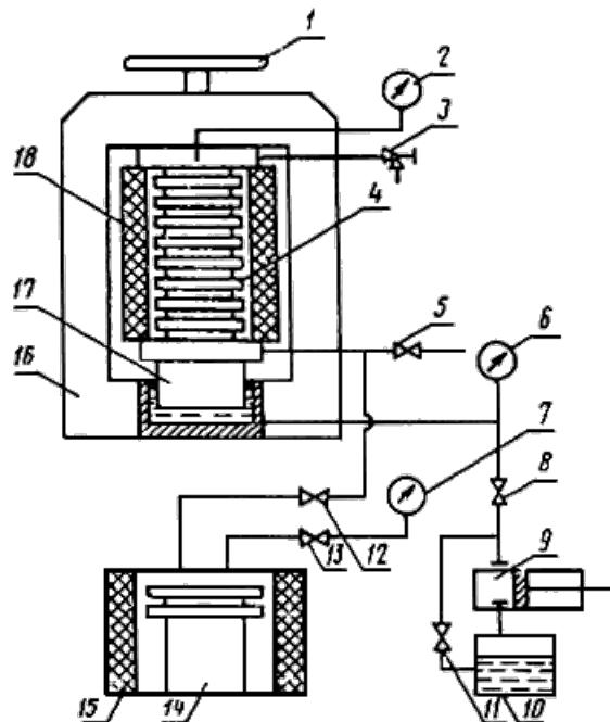
1 - штурвал; 2, 6, 7 - манометр; 3 - вентиль продувочный; 4 - фланцевый коллектор; 5 - вентиль для спуска пара из коллектора;
